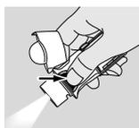
ミスト(霧)が見えるまで5)~7)を繰り返す。ミスト(霧)が見えてから5)~7)の操作をさらに3回繰り返し、噴霧が確実に進むことを確認する。
